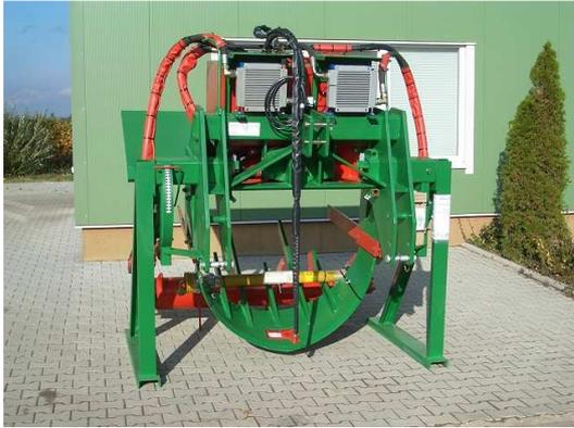
Der Rodepflug Baugröße XL ist für Traktoren bis 310 PS / 228 kW (Zapfwellenleistung) ausgelegt.
