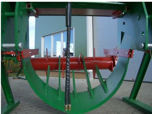
Das Rodeschar hat Stabilisierungen in Längs- und Querrichtung, so dass das ganze Gerät sehr robust ist und auch großen Kräften stand hält.
