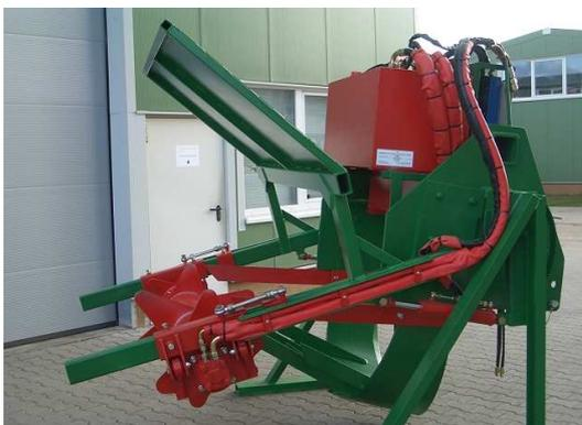
Stattdessen ist ein großdimensioniertes Getriebe, für den Dauereinsatz konzipiert, direkt am Rodepflug integriert. Der Antrieb erfolgt über eine Zapfwelle.
